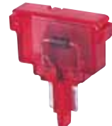
Diodenstecker rot, DSRT mit Diode 400 Volt 1A - die Stecker kön- nen nicht falsch eingesteckt werden. (der Diodenring zeigt zum starren Klem- menfuß)
