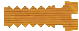
Gefüge einer gedrehten Schraube
