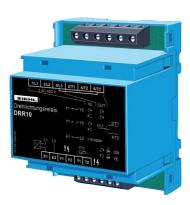
Drehrichtungsrelais vom Typ DRR10 messen beim Einschalten der Spannung die Richtung des Drehfeldes und stellen, wenn nötig, durch den Tausch von 2 Phasen ein korrektes Drehfeld her.
