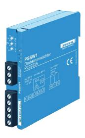
Drehstromwächter vom Typ PSSW1 überwachen Drehstromnetze auf Phasensymmetrie, Phasenfolge, Unter- und Überspannung, schützen damit Motoren vor Schäden und sorgen für längere Lebensdauer.
