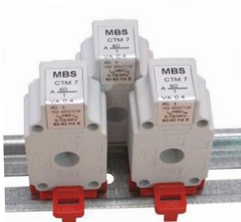
Der CTM7 ist ein besonders kompakter Stromwandler, der auch unter beengten Bedingungen Platz findet. Mit 64 A primär passt er perfekt für Hausanschlüsse, die üblicherweise mit 63 A abgesichert werden. Die 1 A des Ausgangs werden an die Strommesseingänge des EFR3000 angeschlossen. Das EFR3000 ist für Stromwandler 60/1 A voreingestellt, die Umparametrierung ist einfach.
