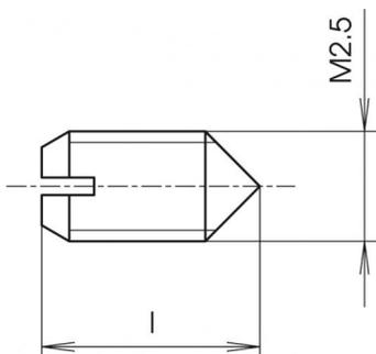
Gewindestift M2,5 x 5 / M2,5 x 8, V2A, zur Positionierung und Erdung des Gewindestreifens
