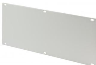
Teilfrontplatten EMV, Alu frontseitig naturfarben eloxiert, rückseitig passiviert mit Schlitz für EMV-Feder und eingepressten Zentrierpin
