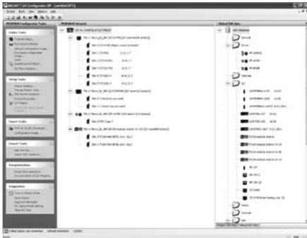
Die Software GX Configurator DP ist eine benutzerfreundliche Konfigurations-Software für das offene Netzwerk Profibus DP. Die Software wird als 32-Bit-Version für MS Windows® XP und Vista geliefert und unterstützt die Parametrierung aller Profibus DP-Module der MELSEC System Q, AnSH/ QnAS-Serie sowie der FX-Familie.
