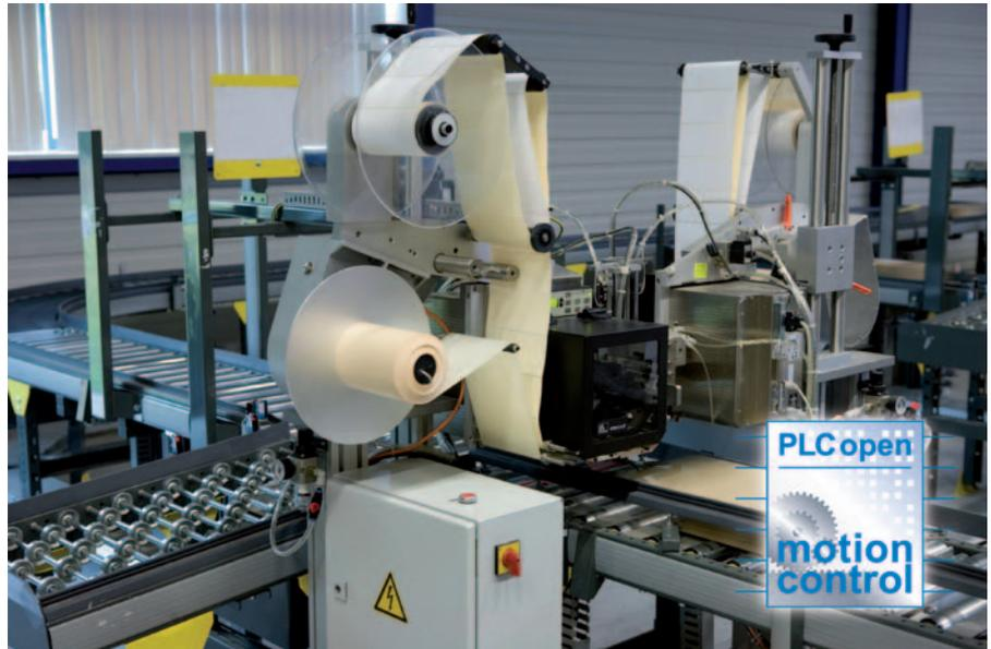
Etikettiermaschine, gesteuert von einer SPS der MELSEC L-Serie in Kombination mit einem Simple Motion Modul.
