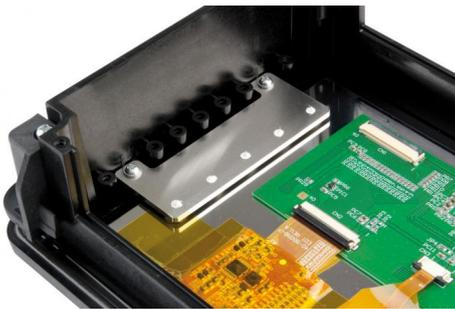
Das Display wird mithilfe einer projektspezifisch hergestellten Halteplatte in einem von BOPLA geschützten Montageverfahren fixiert.
