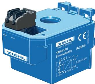
Der STWA1AH ist ein Strommessumformer für AC-Ströme 0...15 A. Mehrfaches Durchschleifen des stromführenden Leiters reduziert den Strombereich entsprechend (z.B. 0...5 A bei 3-fachem Durchschleifen).
