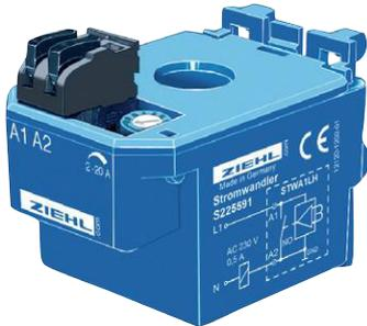
Der Elektronik-Stromwandler STWA1LH überwacht Wechselströme im Bereich 2 ... 20 A. Durch mehrfaches Durchschleifen des überwachten Leiters können entsprechend kleinere Ansprech-
