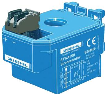
Der STWA1SH verfügt über eine eingebaute Elektronik mit Transistor-Ausgang. Die Schaltschwelle bei 2A. Oberhalb von ca. 2 A ist der Transistor am Ausgang durchgesteuert, unterhalb von ca. 1,5 A gesperrt. Der Wandler wird einfach über den stromführenden Leiter geschoben. Mehrfaches Durchschleifen reduziert die Ansprechschwelle entsprechend, z. B. auf ca. 0,5 A bei 4-fachem Durchschleifen. Eine Versorgungsspannung ist nicht erforderlich.
