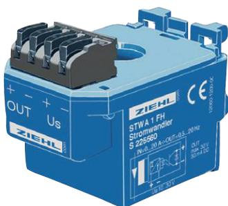
Der STWA1FH verfügt über einen Frequenzausgang 0,5...20 Hz entsprechend 0...20 A Stromfluss durch den Wandler. Mehrfaches Durchschleifen des stromführenden Leiters reduziert den Strombereich entsprechend (z.B. entsprechen 0...5 A bei 4-fachem Durchschleifen 0,5...20 Hz).
