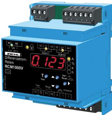
Das RCM1000V überwacht als Differenzstromrelais Fehlerströme in geerdeten Netzen. Als Stromrelais überwacht es Wechsel- oder pulsierende Gleichströme auf Über- oder Unterschreiten von Grenzwerten.
