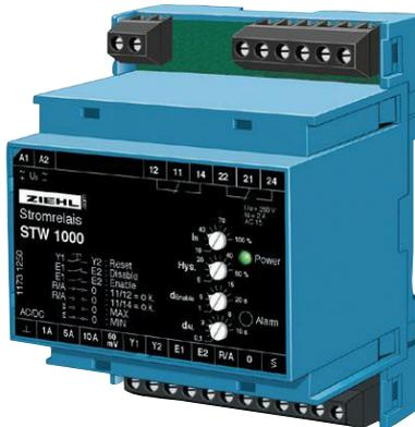
ZIEHL Stromwächter STW1000 überwachen mit 4 Messbereichen die meisten gängigen Gleich- und Wechselströme auf Über- oder Unterschreiten einer eingestellten Schwelle.
