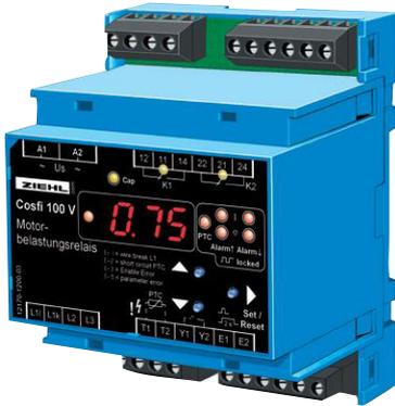
Stromrichtungsrelais COSFI 100V überwachen Wechselströme auf Höhe und Richtung. Erfasst wird der Wirkstrom in einer Phase.
