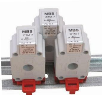
Der CTM7 ist ein besonders kompakter Stromwandler, der auch unter beengten Bedingungen Platz findet. Mit 64 A primär passt er perfekt für Hausanschlüsse, die üblicherweise mit 63 A abgesichert werden. Die 1 A des Ausgangs werden an die Strommesseingänge des EFR3000 angeschlossen. Das EFR3000 ist für Stromwandler 60/1 A voreingestellt, die Umparametrierung ist einfach.
