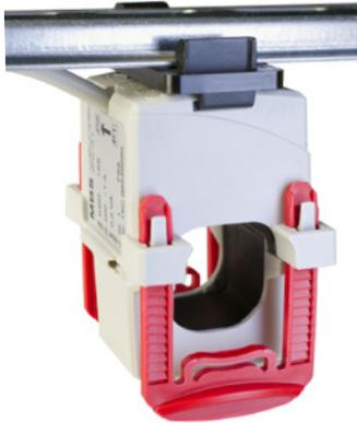
Der KBR18S ist mit seinem teilbaren Messkern besonders geeignet zum nachträglichen Einbau in bestehende Anlagen. Mit 60 A primär passt er perfekt für Hausanschlüsse, die üblicherweise mit 63 A abgesichert werden. Die 1 A des Ausgangs werden an die Strommesseingänge des EFR3000 angeschlossen. Das EFR3000 ist für Stromwandler 60/1 A voreingestellt, sodass die (einfache) Parametrierung entfällt.
