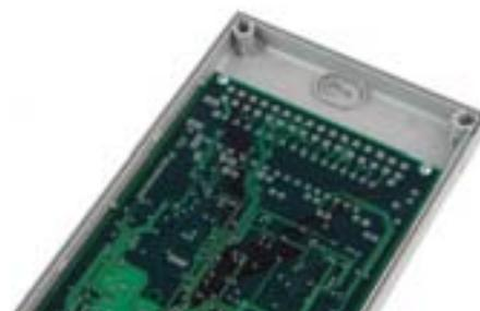
Bei der Modellreihe EG 20.. ist die Position der Nocken speziell auf Europakartenformat (100 x 160 mm) im Unterteil ausgelegt.
