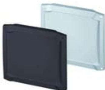
OT-F: Dieser geschlossene Foliendeckel verfügt über eine abgesenkte Fläche für die Montage von Folientastaturen. Die Montage mit dem Unterteil erfolgt durch Verschrauben. Befestigungsnocken an der Unterseite ermöglichen die Montage von Leiterkarten oder Montageplatten.
