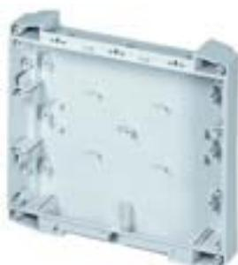
UT-0,5: Speziell die flachen Unterteile in Kombination mit dem Foliendeckel eignen sich für den Einsatz als mobiles Bediengerät. Für eine ergonomische Handhabung lassen sich rückseitig zusätzliche Griffelemente befestigen, die dort vorhandene Montageöffnungen mit abdecken. Die am Unterteil angespritzten Befestigungskonturen für den scharnierten Deckel werden durch eine beiliegende Abdeckung verdeckt.
