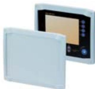
CF: Die Einbaufront verfügt über eine abgesenkte Fläche für die Montage von Folientastaturen und lässt sich mit vier Schrauben optimal mit einer Rückwand verschrauben. Mit der optional erhältlichen Dichtung ist eine Schutzart von IP 65 zur Einbauwand erzielbar.
