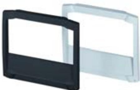
**FO-K:** Der FO-K Rahmen dient zur randseitigen Abdeckung einer Frontplatte (FP...K) und eines Klemmenraumes. Der integrierte Klemmenraumdeckel verfügt über eine 1,5 mm vertiefte Fläche für die Montage von Folientastaturen. Der Rahmen wird auf das Unterteil gesteckt, an zwei Stellen festgedrückt und am Klemmenraum verschraubt. In Verbindung mit Unterteil und Frontplatte: Schutzart IP 40.
