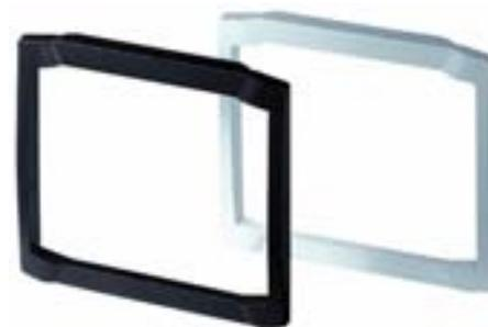
FO: Der FO-Rahmen dient zur randseitigen Abdeckung einer durchgehenden Frontplatte (FP). Die Montage am Unterteil erfolgt durch Aufstecken und Festdrücken. In Verbindung mit Unterteil und Frontplatte: Schutzart IP 40.
