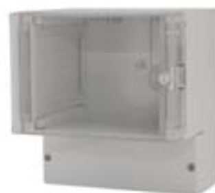
IC 5000: IP 65, glasklarer Deckel, Scharnier (Scharnierseite wählbar), Schnappverschluss; verfügt über eine Vielzahl horizontaler und vertikaler Einschubnuten.
