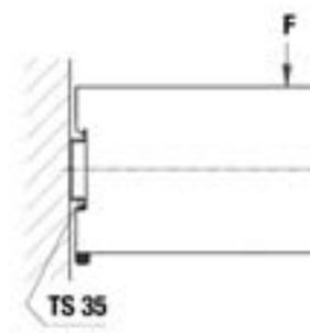
Rastfuß für die Schienenbefestigung (werksseitig montiert); Belastbarkeit, F = max. 40 N ruhende Last
