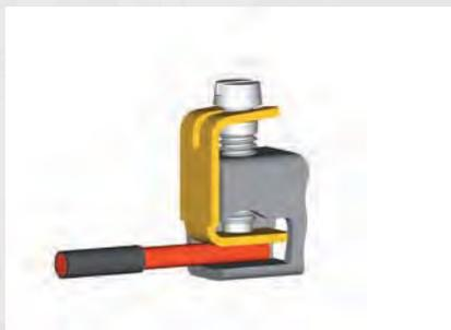
Direkte Klemmdruckübertragung auf den Draht bei vollem Klemmschraubenquerschnitt und Schonung des Drahtes (kein Zerspleißen oder Durchstoßen durch den Fuß der Klemmschraube)
