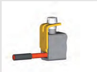
Sicherung gegen Schraubenlockerung bei Vibrationen durch den gegen den Schraubenkopf federnden Drahtbügel (damit sind die Schrauben unverlierbar).
