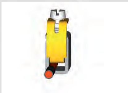
Sicherheit gegen Kippen des Anschlusses (durch den aus einem Stück gefertigten Metall-Klemmkörper ist es nicht möglich, dass die Anschluss-„Käfige“ bei Anschluss eines dünnen Drahtes kippen)
