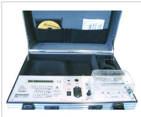
Zum Testen von LSA-Magazinen, die mit Gasentladungsableitern bestückt sind. Im Koffer ist das Prüfgerät fest eingebaut und hat darüber hinaus noch Platz für die Zubehör (z. B. Netzadapter, Magazinadapter für verschiedene Magazintypen).
