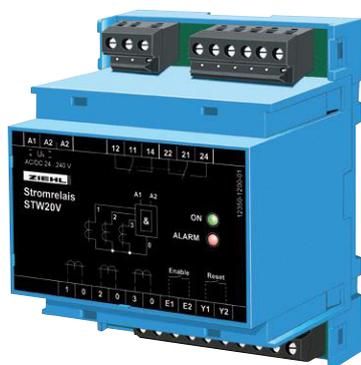
Das Stromrelais STW20V überwacht 3 Stromkreise auf Stromfluß ja nein. Fließt in allen 3 überwachten Leitungen ein Strom, so ist das eingebaute Relais (2 Wechsler) angezogen. Fließt in mindestens einer Leitung kein Strom, so schaltet das Relais unverzüglich ab.
