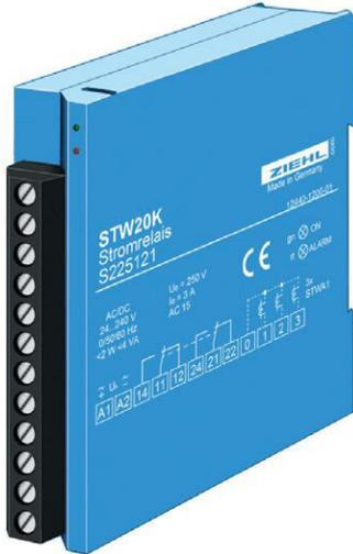
Das Stromrelais STW20K überwacht 3 Stromkreise mit Stromwandlern STWA 1 auf Stromausfall (UND-Schaltung). Fließt in allen 3 überwachten Leitungen ein Strom, so ist das Relais (2 Wechsler) angezogen. Fließt in einer Leitung kein Strom, so schaltet das Relais unverzüglich ab. Das Relais arbeitet in Ruhestromausführung. Bei Netz wiederkehr erfolgt daher eine Störmeldung auf dem Ruhekontakt, bis das Relais angezogen hat.
