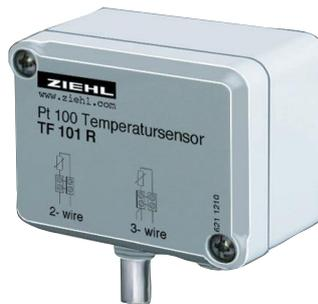
Raumtemperatursensor für Innen- und Außenmontage. Schutzart IP 54, Kabelzuführung über Verschraubung M12. Für Weiterleitung in 2- oder 3-Leitertechnik geeignet.
