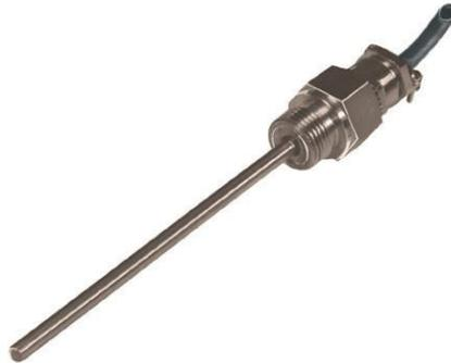
Messwiderstand eingebaut in Edelstahlrohr V4A mit Einschraubgewinde 1/2 Zoll zum Einbau in Rohrleitungen. Ansprechzeit  $T_{0,9}$  in Luft 255 s, in Wasser 45 s. Für Weiterleitung in 2- oder 3-Leitertechnik geeignet.
