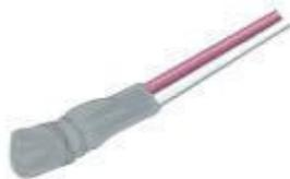
Sensor, in Streichholzgröße, mit Schrumpfschlauch geschützt. Die Bauform TF101/K eignet sich zum Einbau in Trafo- und Motorwicklungen. Beim Einbau in Wicklungen ist darauf zu achten, dass der Messwiderstand keinem Druck ausgesetzt wird und keine Zugbelastung auf das Kabel entsteht. Ansprechzeit  $T_{0,9}$  in Luft 100 s, in Wasser 19 s.
