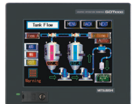
Das GOT ist ein typisches grafisches Bediengerät.
