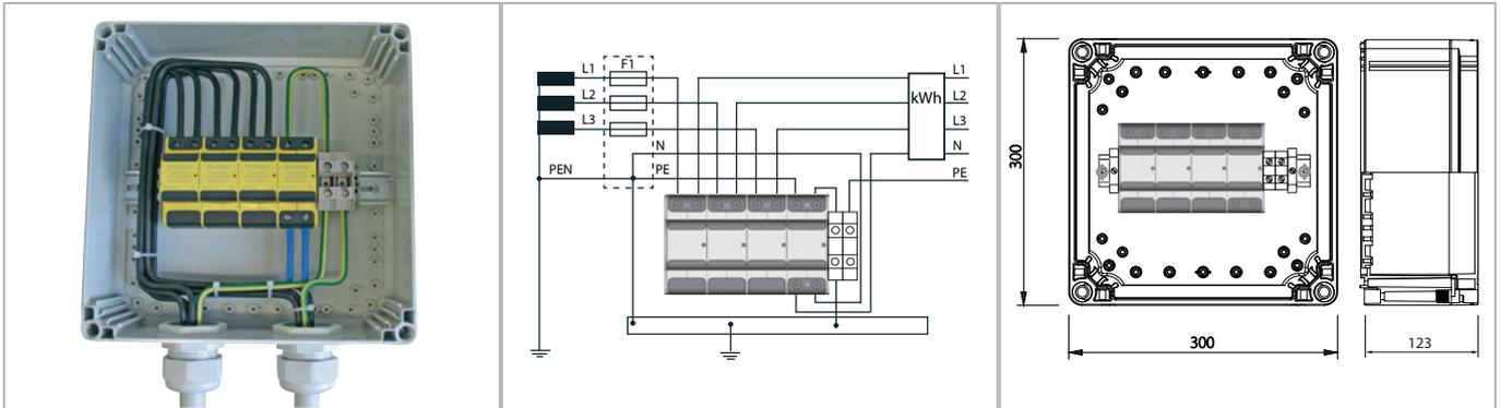
Anschlusskasten im Vorzählerbereich für 3-phasige TT- oder TNS-Netze nach DIN VDE 0100-443 und -534. Blitzstromableiter mit sehr niedrigem Schutzpegel von kleiner 1,5 kV auf Basis gasgefüllter Funkenstrecken. Diese ermöglichen ein extrem hohes Ableitvermögen bei gleichzeitig niedrigem Schutzpegel und benötigen keine empfindliche interne oder externe Triggerelektronik.
