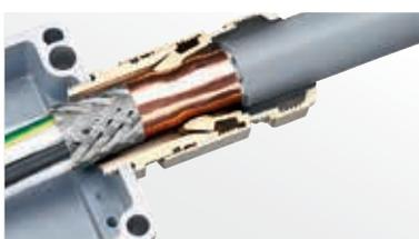
**Progress® EMV-Kabelverschraubungen** aus Messing sorgen für eine niederimpedante Verbindung zwischen Schirmgeflecht und Metallgehäuse bei einer gleichzeitig sicheren Kabeleinführung.
