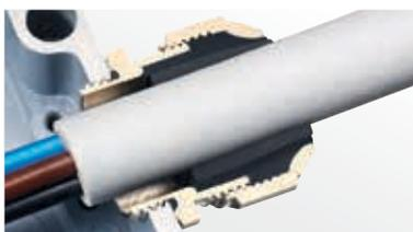
**Progress® Kabelverschraubungen** aus Kunststoff oder Metall sind bewährte Helfer für die fachgerechte Kabeleinführung in Industrieanlagen. Die herausragende Kompressionstechnik sorgt für eine hohe Dichtigkeit und eine äusserst kabelschonende Zugentlastung.
