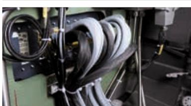
**AGROflex** Geflechschläuche in Polyester und Polyamid zur Bündelung und Ummantelung elektrischer Leitungen.
