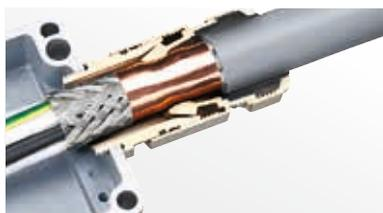
**Progress® EMV-Kabelverschraubungen** aus Messing sorgen für eine niederimpedante Verbindung zwischen Schirmgeflecht und Metallgehäuse bei einer gleichzeitig sicheren Kabeleinführung.
